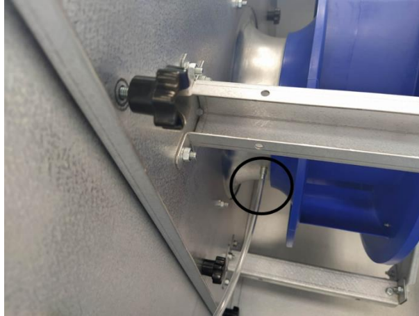
Şekil 28. Fan basınç hortumu bağlantısının cihaz içerisindeki yerinin gösterimi.
