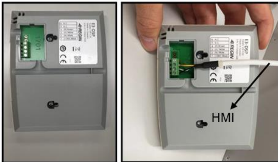
Şekil 17. HMI kablosunun ekrana bağlantısının gösterimi.
