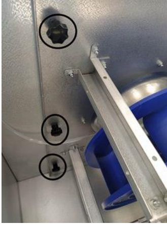
Şekil 29. Fan servis vidalarının çıkartılmasıyla beraber fanın cihazdan ayrılmasının gösterimi.
