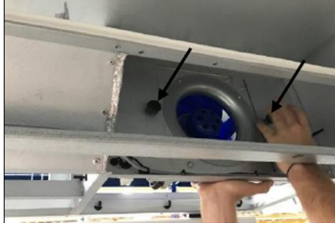
Şekil 29. Fan servis vidalarının çıkartılmasıyla beraber fanın cihazdan ayrılmasının gösterimi.
